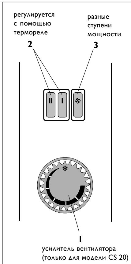
Если используется прибор CS 20 (L), можно усилить процесс выхода горячего воздуха через дополнительную, отдельно расположенную решетку, используя встроенный вентилятор (5).
