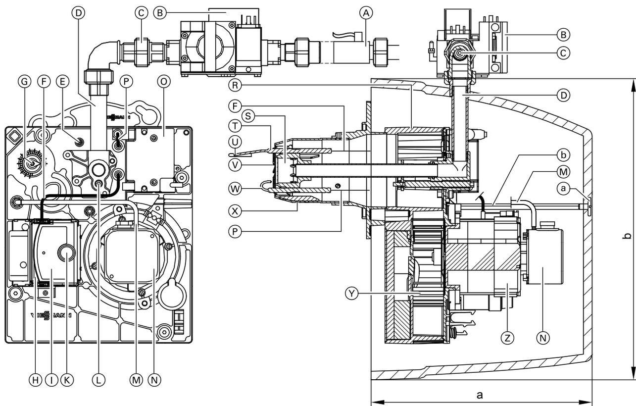
5829 450 GUS (A) Запорный газовый кран со встроенным предохранительным клапаном
