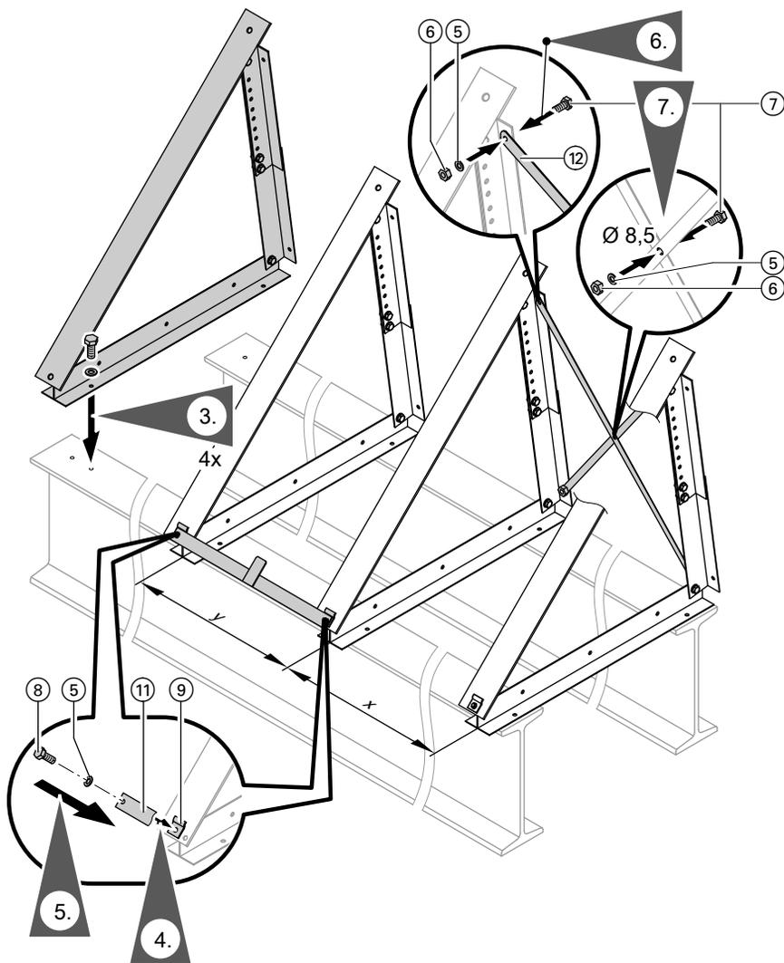
Использовать опорные стойки в качестве шаблона для сверления.
