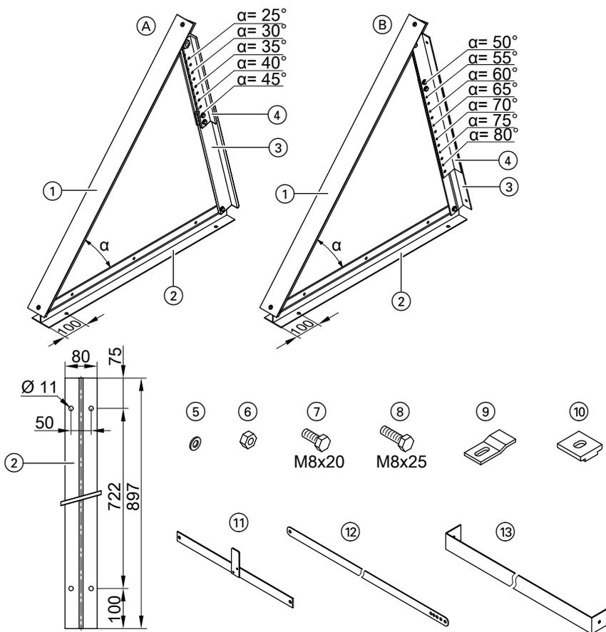
(A) Коллекторная опора для угла наклона  $\alpha$  25 - 45°
