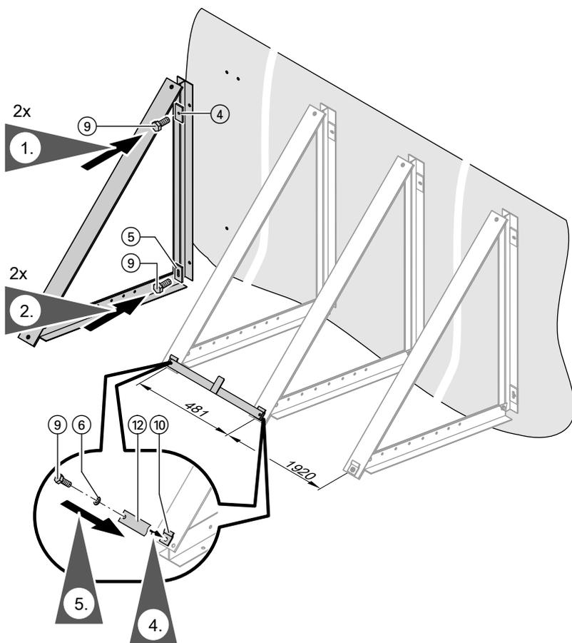
Использовать опорные стойки в качестве шаблона для сверления.
