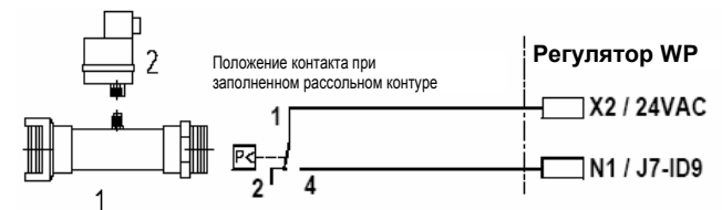
Рис 3.1.с: Датчик падения давления рассола (установка и схема включения)
