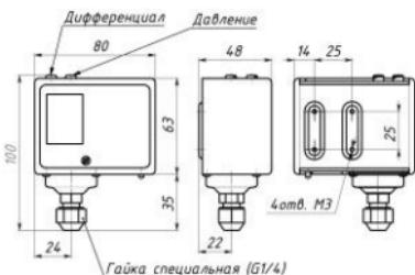
Рис.4 Габаритные и присоединительные размеры модели 35
