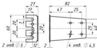
Рис.5. Кронштейн для монтажа модели 35
