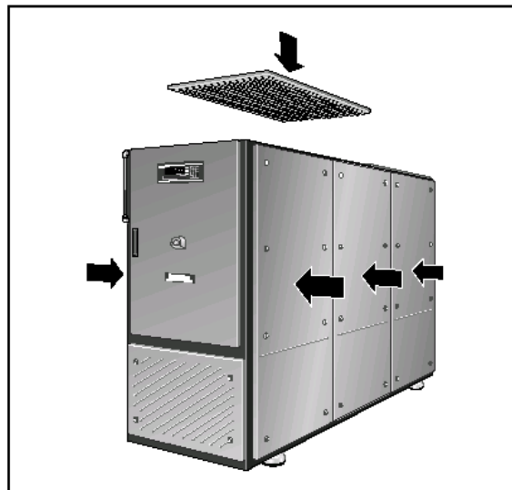
Рис. 14 Монтаж элементов шумопоглощающего кожуха
