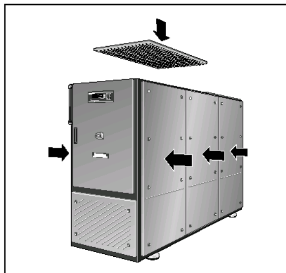
Рис. 14 Монтаж элементов шумопоглощающего кожуха
