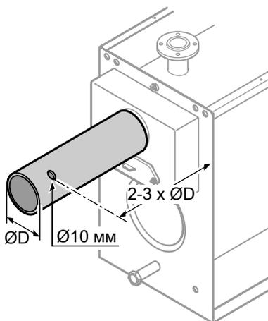
1. Соединить патрубок уходящих газов с дымоходом кратчайшим путем и с небольшим подъемом. Наружный Ø патрубка уходящих газов:
