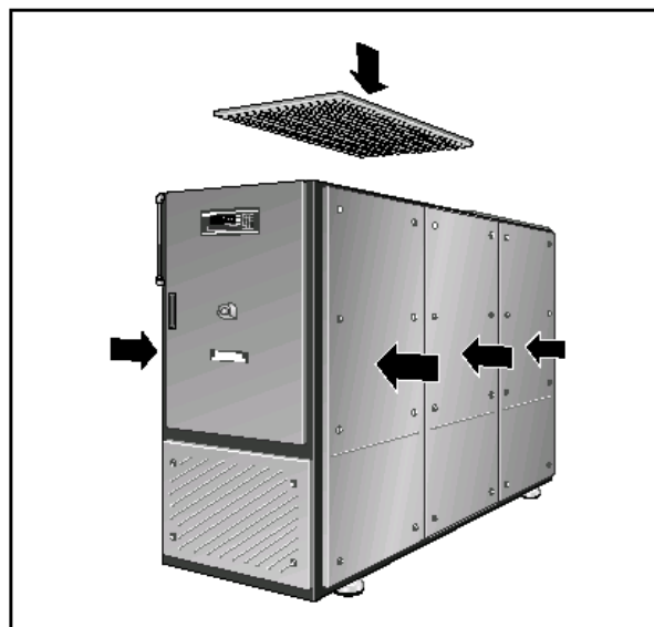
Рис. 14 Монтаж элементов шумопоглощающего кожуха
