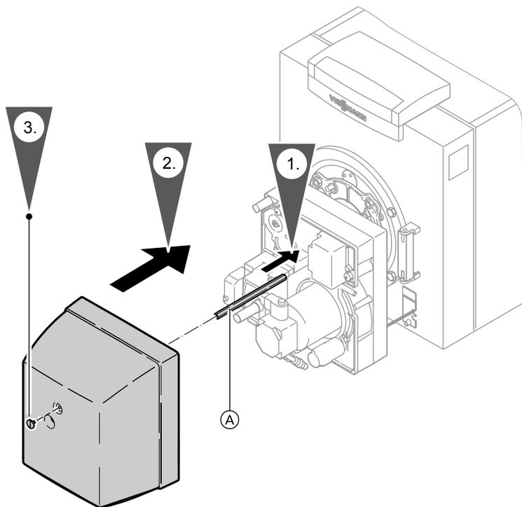
1. Ввинтить удерживающую штангу (A) для колпака горелки в предусмотренное для этого резьбовое отверстие М 6 на крышке горелки (удерживающая штанга входит в комплект поставки горелки).
