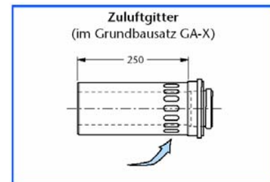
Zuluftgitter (im Grundbausatz GA-X) = Решётка приточного воздуха (в основном монтажном комплекте GA-X)
