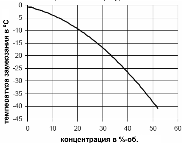
Рис. 3.1.а: Кривая замерзания смеси воды с моноэтиленгликолем в зависимости от концентрации
