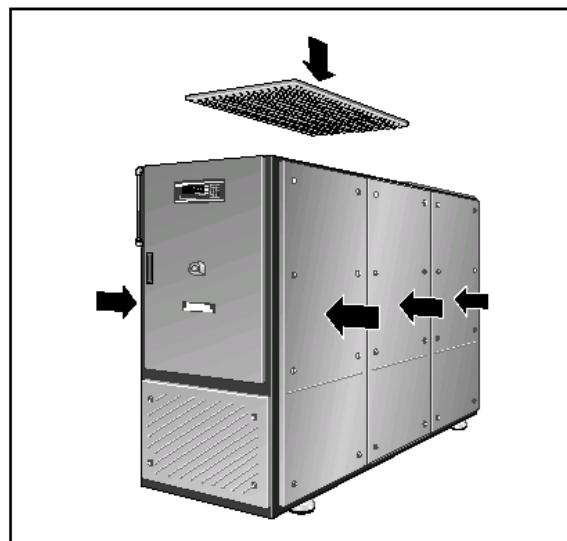
Рис. 13 Монтаж элементов шумопоглощающего кожуха
